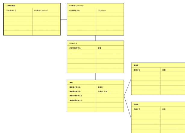
図 2 CRC カードからクラス構造を導出
